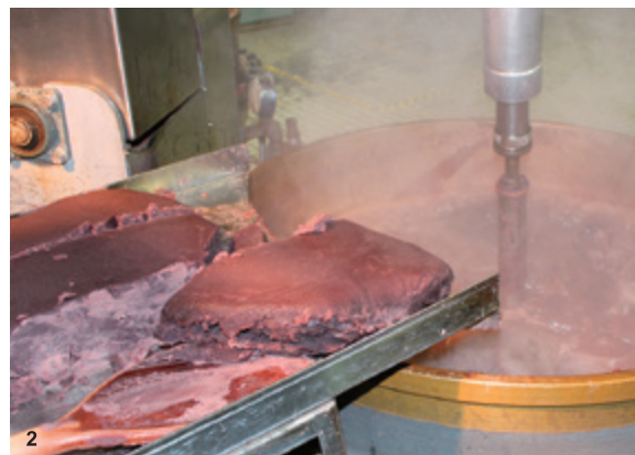
1. 「ぴーなつつ最中」の製造ライン 2. 煉釜に入れられる羊羹原料 3. 羊羹の充填機
